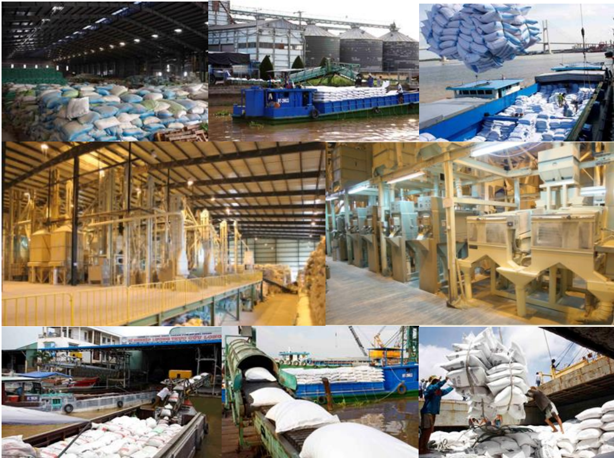
Một số hình ảnh về kho chứa, dây chuyền xay lúa, Dây chuyền xay – xát lau bóng, Dây chuyền xát trắng lau bóng
